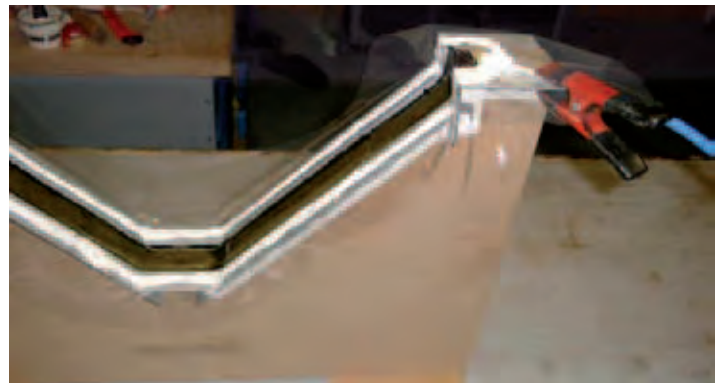
Vakuum anlegen oder allenfalls mit Gegenform pressen.
