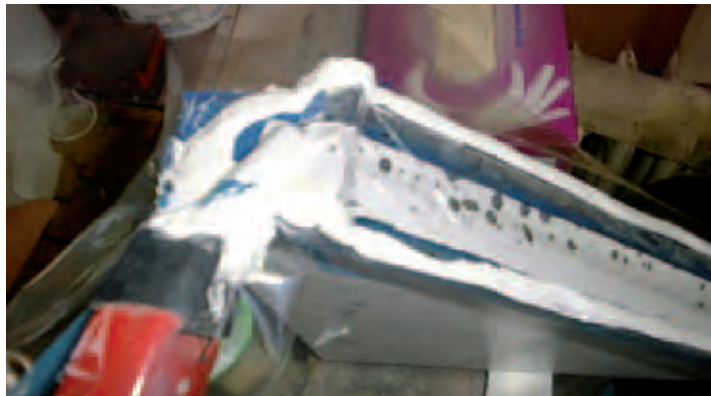
Formenrand mit Acrylat abspritzen und Absaugfolie auflegen.
