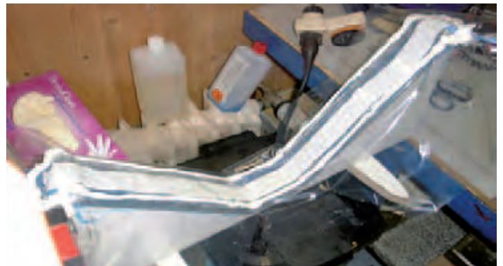
Bei der Vakuum-Methode Abreissgewebe und Saugvlies nicht vergessen!
