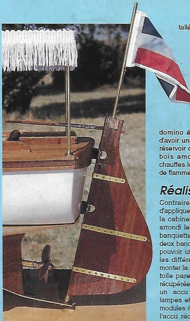
**Le souci des détails, un magnifique gouvernail en bois verni avec ses ferrures en laiton,**
